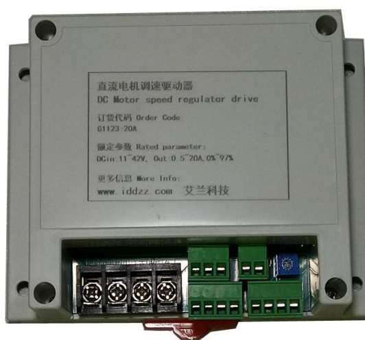
20A配外壳 (配外壳散热能力降低)
