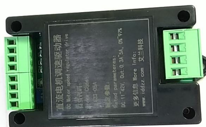
5A配外壳 (带外壳散热能力会降低)
